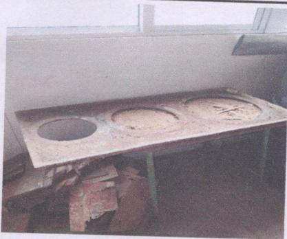
Foto 5: Plancha de cocina esta completamente oxidada
